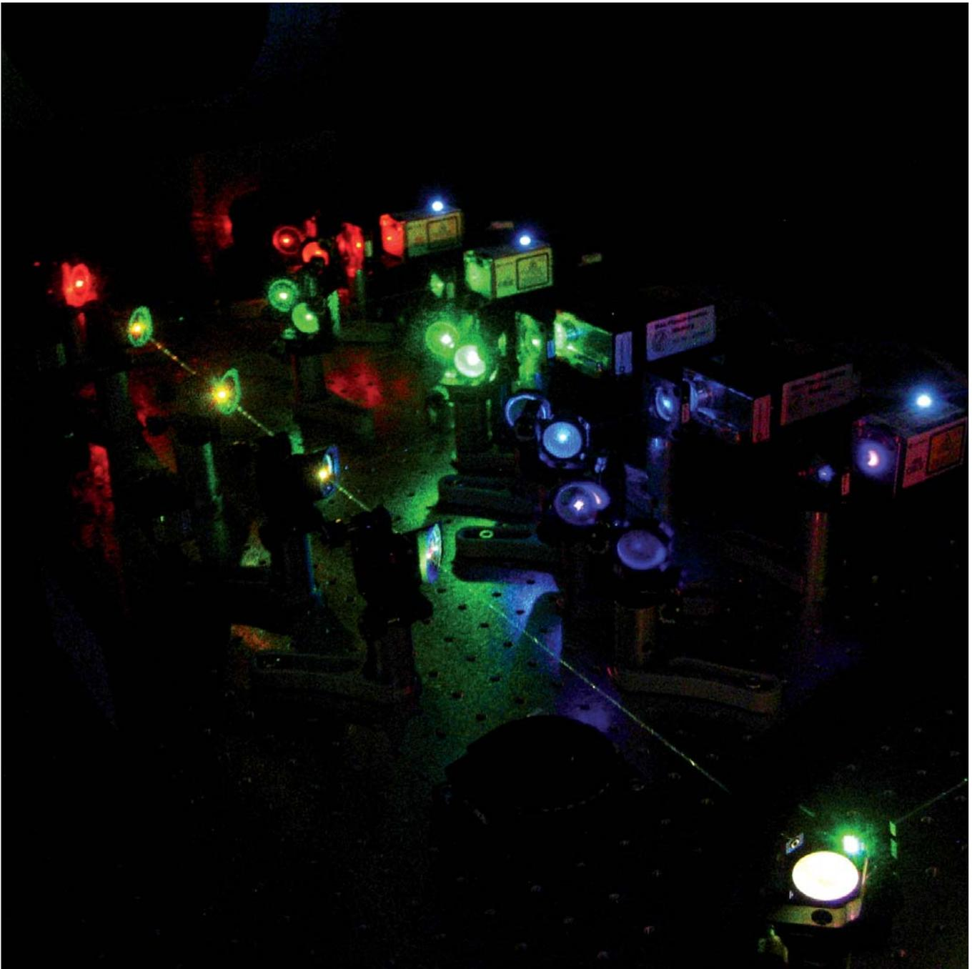
*Rote, grüne und blaue Laserstrahlen werden über verschiedene Spiegel übereingeführt, bevor sie als ein gemeinsamer Strahl in das Fluoreszenzmikroskop eingekoppelt werden. Dort bringen sie markierte Proteine von Lebendzellen zum Leuchten. Mit der Methode lassen sich einzelne Bestandteile und die Struktur einer Zelle untersuchen.*
